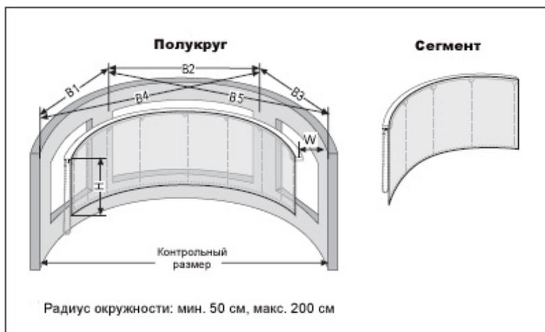
При заказе карнизов особой формы, рекомендуется прилагать чертежи с размерами в мм или шаблон:
