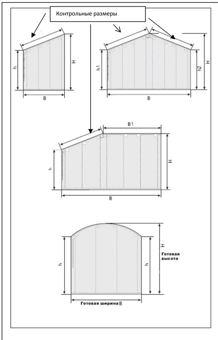
При заказе карнизов особой формы, рекомендуется прилагать чертежи с размерами в мм или шаблон:
